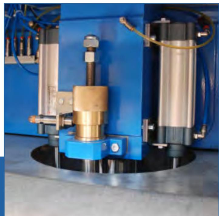
Sistema pneumatico di pressione e contropressione con doppio pistone
