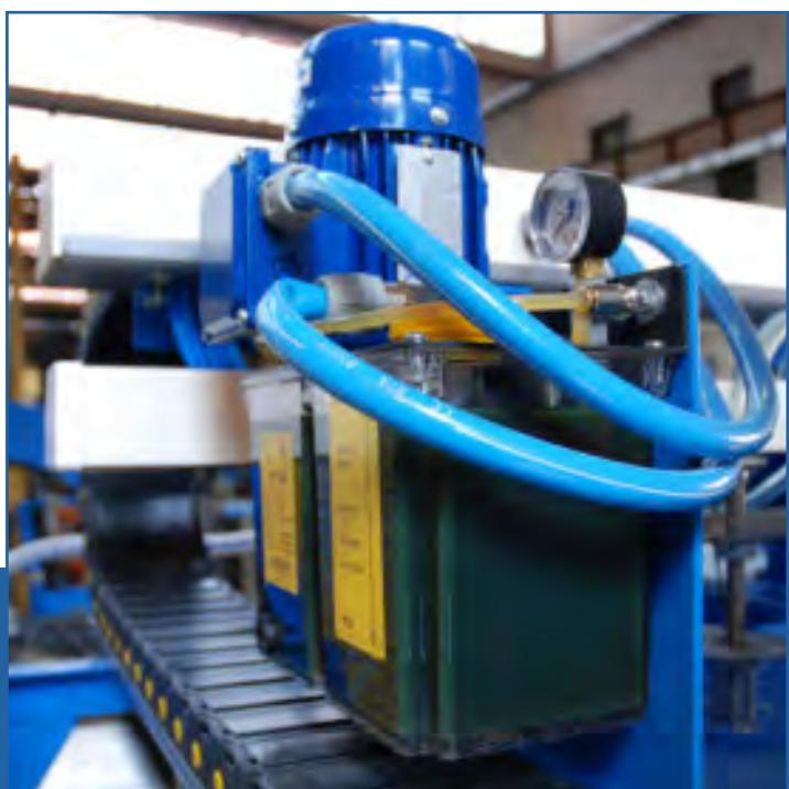
Lubrificazione automatica con pompa temporizzata
