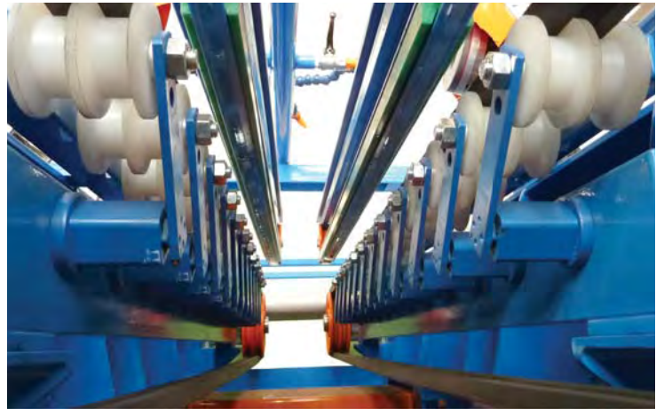
Trasporto con spinta verso l'alto e piano di riscontro - Transport with upward push and fixed surface plate - Transporte avec poussée vers haut et marbre à dresser - Transporte con empuje hacia arriba y plano de apoyo.
