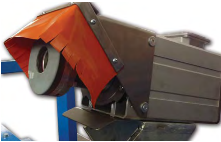
Particolare testa di bisellatura - Detail of chamfering head - Détail tête de Chain freinage - Detalle del cabezal de biselado.
