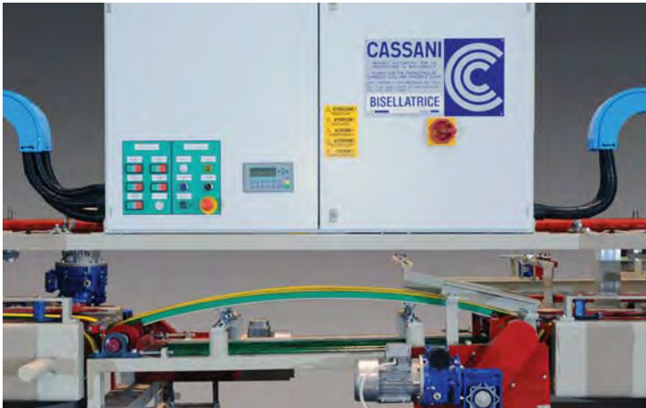
Girello mattonella per modello L 20/60 4D - Rotating device for model L 20/60 4D - Dispositif pour tourner 90° les carreaux pour model L 20/60 4D - Giro de baldosa para el modelo L 20/60 4D.
