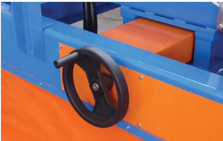
Regolazione delle guide di contenimento - Adjustment of the tiles guides - Réglage guides de endiguement - Regulación de las guías de contención.
